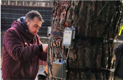
Sono stati effettuati dei **test sperimentali** finalizzati alla **calibrazione della sensoristica** deputata alla misurazione del **sapflow**.
