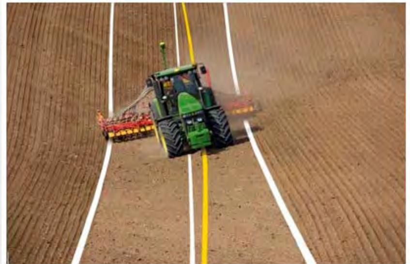
Il sistema di posizionamento geografico oltre a mantenere paralleli i passaggi contigui evitando le sovrapposizioni, è utile anche a garantire l'allineamento fra trattore e operatrice.
