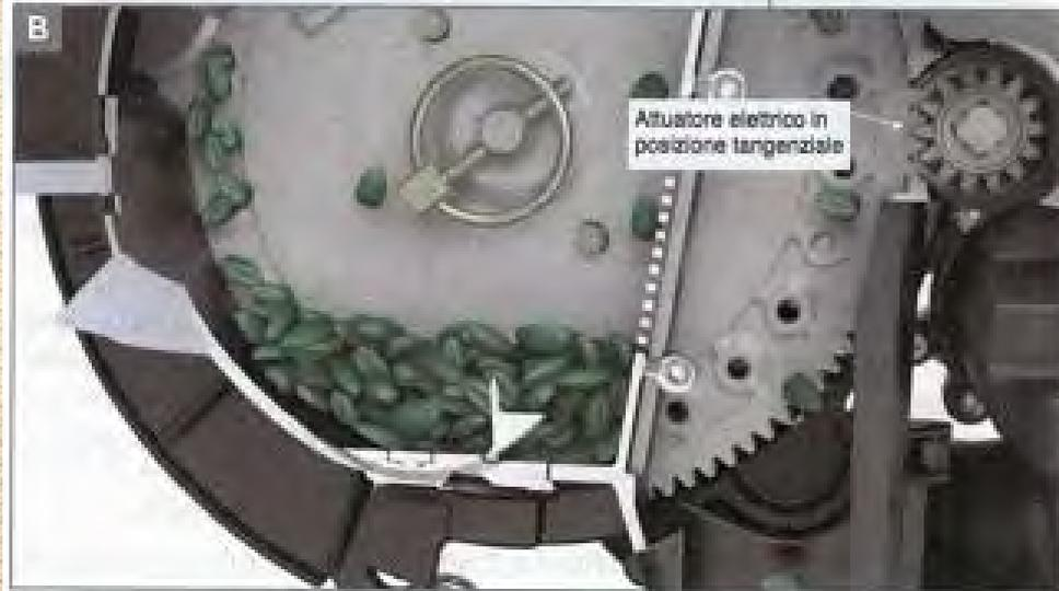
I motori elettrici per l'azionamento del disco distributore possono essere applicati nelle seminatrici di precisione in posizione assiale (a) e in posizione tangenziale (b). In quest'ultimo caso il disco viene completamente ridisegnato.
