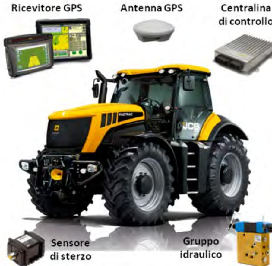
**Elettrovalvola proporzionale** inserita nel circuito idraulico del trattore.
